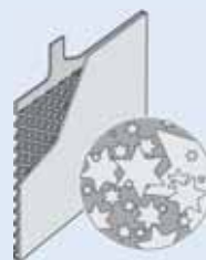
BEZ CARBON BOOST® Dosky sú pokryté síranom
